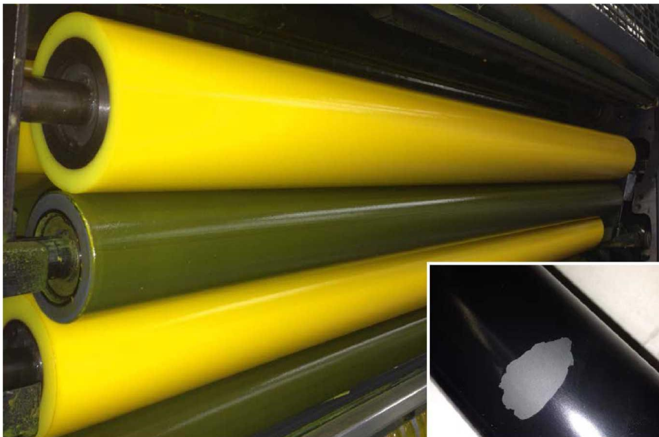
Obraz 3+4: DURAPRINT po ok. 2 latach pracy (po lewej) i walec z konkurencyjną powłoką po ok. 3 tygodniach pracy (po prawej)
